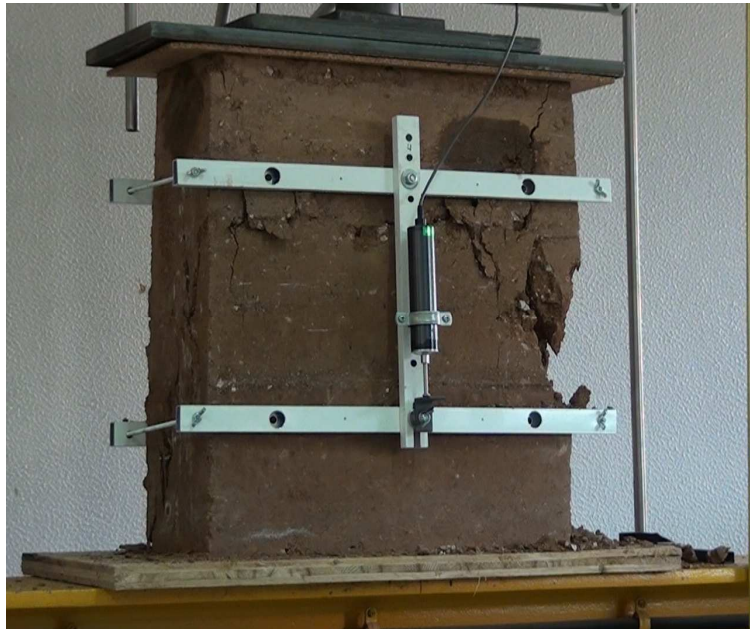
Figura 3: Ensaio de um provete de taipa à compressão ( 200 \times 500 \times 600 [mm]).
