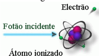
Figura 12 – Representação do efeito fotoelétrico, onde o fóton incidente utiliza toda a sua energia para ionizar um átomo, libertando-se um electrão. (Adapt. de: http://www.ndt-ed.org/EducationResources/CommunityCollege/Radiography/Physics/attenuation.htm , em 13 de Outubro de 2008.)
