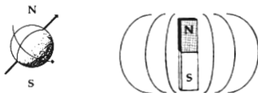
Fig. 2.37 – Aproximação de um spin a um ímã (momento magnético que gira em torno de um eixo). (adapt. R.B. Lufkin, 1990)
