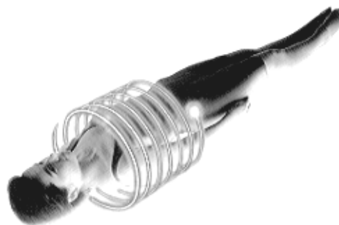
Fig. 2.20 - Esquema do movimento do feixe de raios-X relativamente ao doente, realizado nos equipamento de TAC helicoidais. (retirado da www em 2 de Outubro de 2006: http://www.toshiba.co.jp/tech/review/1997/05/a08/fa08z2.htm )
